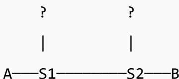
Nella seguente rete l'ID dello switch Sn è n, quindi S1 sarà la radice. Quali collegamenti finiscono per essere "potati" dall'algoritmo spanning-tree e perché? Diagrammate la rete formata dai collegamenti sopravvissuti.
